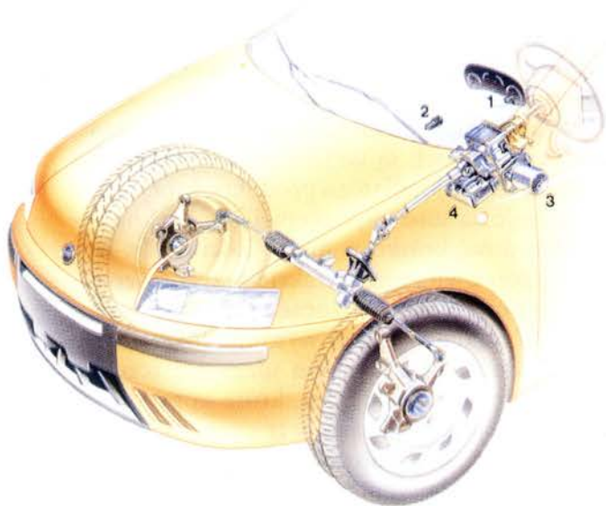
Rys. 1) Układ kierowniczy ze wspomaganie elektrycznym „DUALDRIVE” zastosowany w nowym PUNTO.
