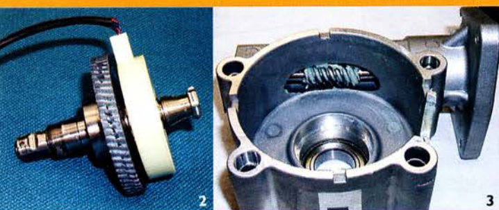
foto 2: Czujnik sprężystych odkształceń skrętnych z kołem zębatym – ślimacznica (oś kolumny kierownicy)
