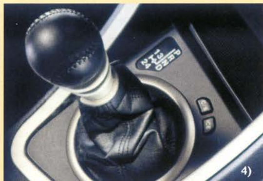
3) Sygnalizacja wizualna w zestawie wskaźników. • 4) Dźwignia zmiany biegów Q-systemu wychylona w prawo – działanie jak dla automatycznej skrzyni biegów, wychylona w lewo – działanie tradycyjne w układzie litery H 5) Dźwignia systemu Sportronic. • 6) Wnętrze samochodu ALFA ROMEO 166 Sportronic
