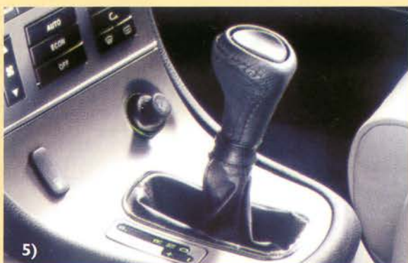
3) Sygnalizacja wizualna w zestawie wskaźników. • 4) Dźwignia zmiany biegów Q-systemu wychylona w prawo – działanie jak dla automatycznej skrzyni biegów, wychylona w lewo – działanie tradycyjne w układzie litery H 5) Dźwignia systemu Sportronic. • 6) Wnętrze samochodu ALFA ROMEO 166 Sportronic
