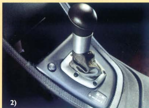
2) Dźwignia zmiany biegów systemu Selespeed przypominająca w działaniu „joystick” komputera.
