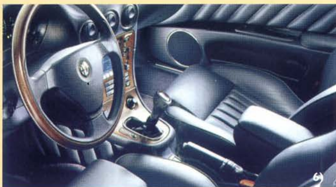
3) Sygnalizacja wizualna w zestawie wskaźników. • 4) Dźwignia zmiany biegów Q-systemu wychylona w prawo – działanie jak dla automatycznej skrzyni biegów, wychylona w lewo – działanie tradycyjne w układzie litery H 5) Dźwignia systemu Sportronic. • 6) Wnętrze samochodu ALFA ROMEO 166 Sportronic
