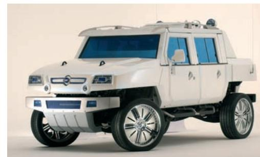
i może on zmieścić do pięciu pasażerów przy obciążeniu użytkowym około trzech ton. Dzięki stałemu napędowi 4x4, wysokiemu prześwitowi (50 cm) i bardzo skutecznemu systemowi zawieszeń niezależnych, może zmierzyć się z każdą sytuacją i trasą: może pokonać nachylenie boczne 40%, i wzdużne 80%.
